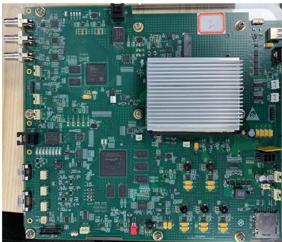
基于高性能嵌入式 GPU 的原型系统处理主板实物图
