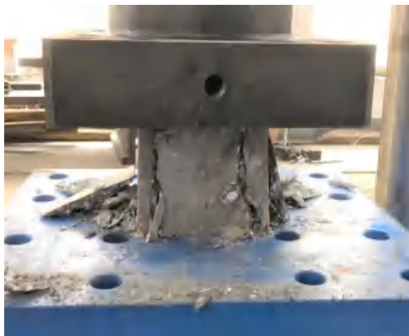
图 4.4.3- 11 混凝土材性试验测试图
