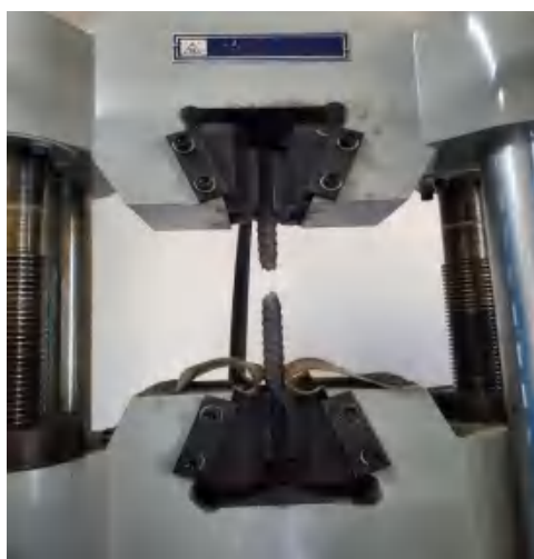
图 4.4.4-9 钢筋材性试验测试
