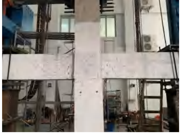
(d) 核心区产生裂缝
