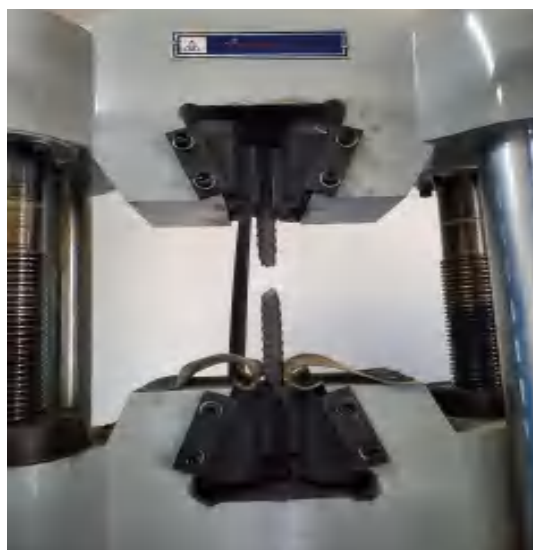
图 4.4.3-12 钢筋材性试验测试
