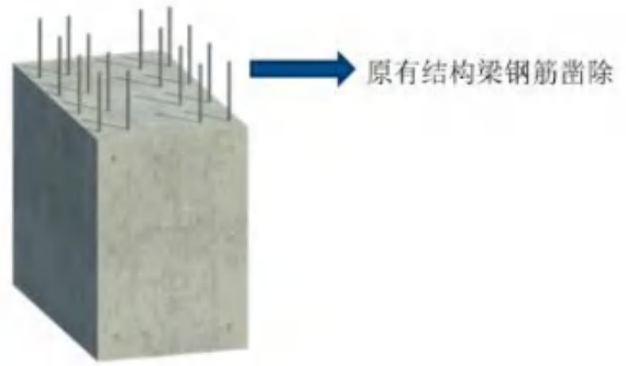
工序一：凿断原有梁钢筋
