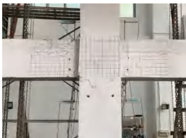
(a) 梁端开始产生裂缝
