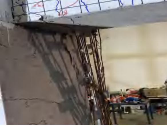
(e) 柱扩散角处裂缝宽度达 1cm
