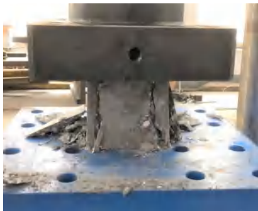
图 4.4.4-8 混凝土材性试验测试图
