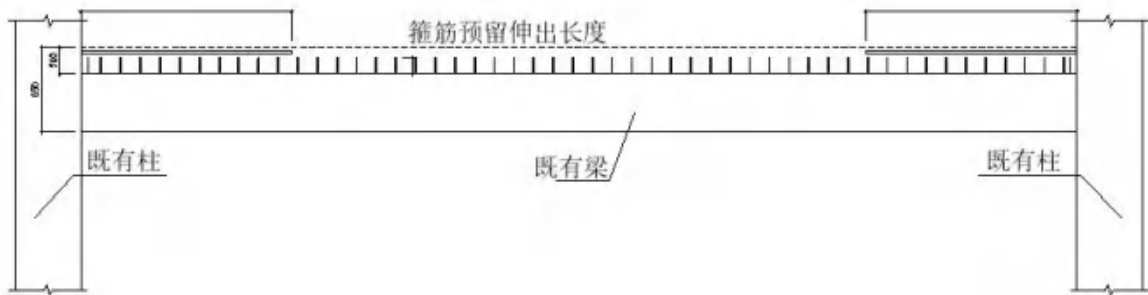
图 4.4.1- 7 既有梁顶面凿除
