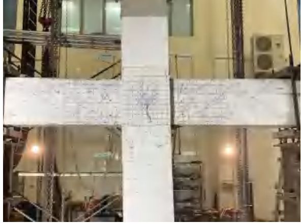
(f) 核心区一条裂缝宽度达 8mm
