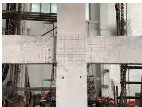
(b) 梁端裂缝向中性轴发展
