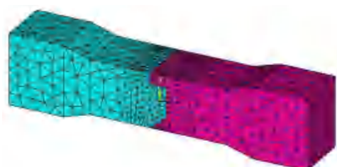
图 4.2.2- 21 企口缝轴拉有限元模型
