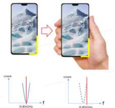
图 2 用户使用手机时对天线频偏影响
