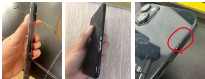
图 2 7 系铝合金手机中框使用后的掉膜现象
