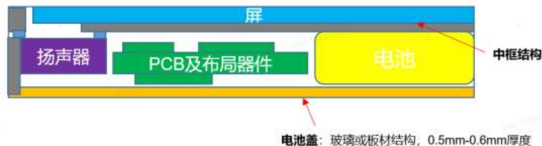
图 2 开放后腔的上扬声器堆叠设计
