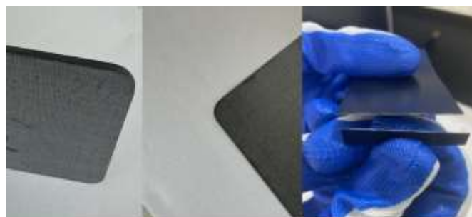
a. UPE截面发黑 b. 切割边缘发黑异色 c. 切割边缘UPE卷边
