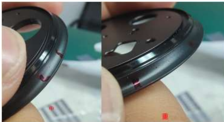
图 3 Al-Mn 系压铸铝合金产品表面的砂孔缺陷
