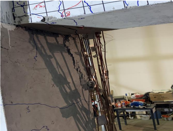
(e) 柱扩散角处裂缝宽度达 1cm
