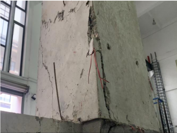
(g) 柱扩散角混凝土剥落
