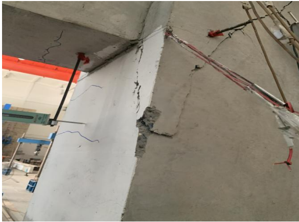
(c) 核心区裂缝延伸至柱扩散角
